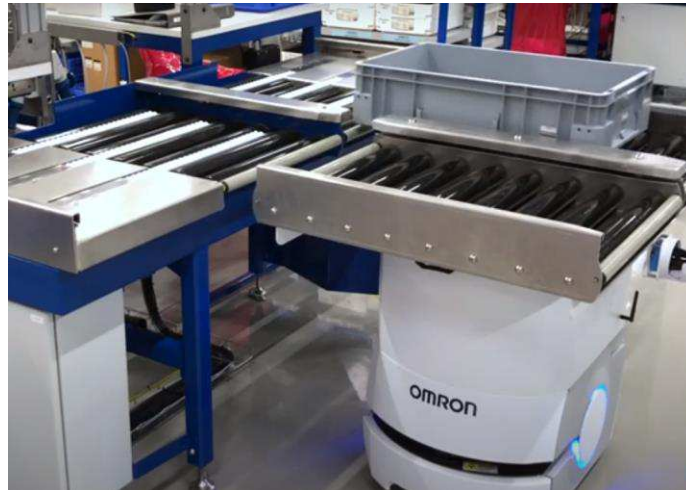
Imatge C.5. Robot autònom OMRON equipat amb rodets motoritzats (Font: Youtube, CesTek).
