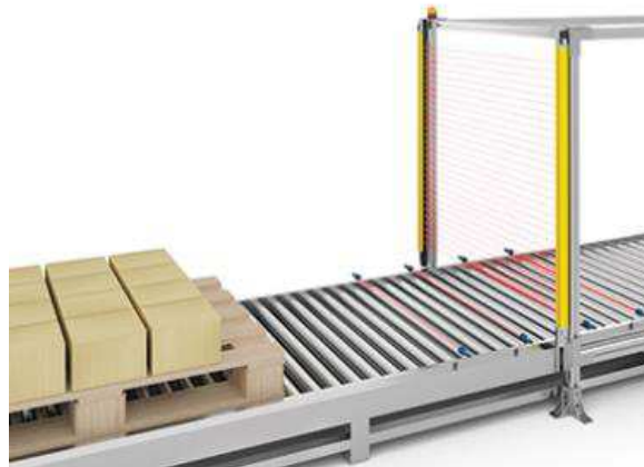
Imatge C.20. Exemple d'aplicació barres de llum infraroja. (Font: web ABB)
