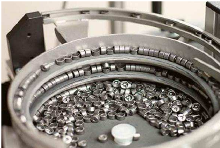
Imatge C.2. Alimentador de peces per vibració (font: raincitygrill.com)
