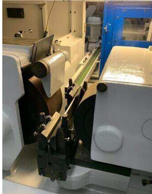
Imatge C.4 Rectificadora sense centres amb el plonge obert i cinta transportadora (font: solostocks.com)
