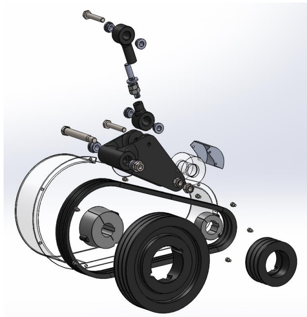
Ilustración 20 Subensamblaje explosionado transmisión recogedor
