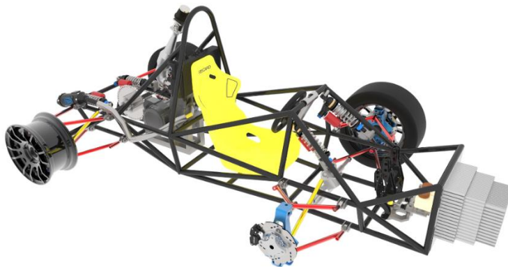
Figura 1.7. Representació del sistema de suspensió d'un vehicle de la Formula SAE. [ https://abhijeetscad.wordpress.com/2015/01/03/fsae-car/ ].
