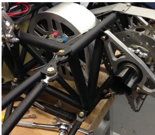
Figura 1.56. Exemple de punts d'ancoratge i unions del sistema de suspensió posterior al xassís. Penn Electric Racing [15].
