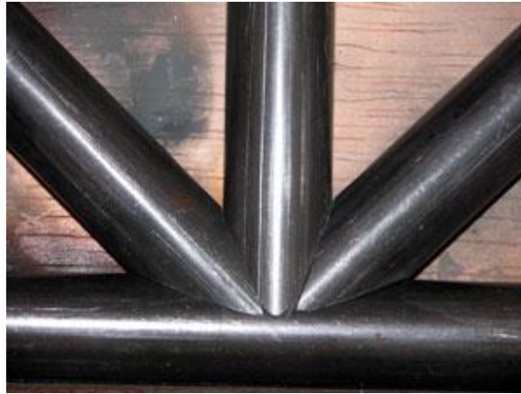
Figura 1.62. Exemple 2 d'unió soldada de tubs. [ http://ururecli.blogspot.com/2012/05/maquina-para-realizar-boca-de-pescado.html ].
