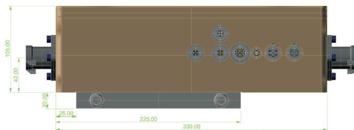
Figura 1.46. Vista frontal del controlador BAMOCAR D3. Unitek Industrie Elektronik.
