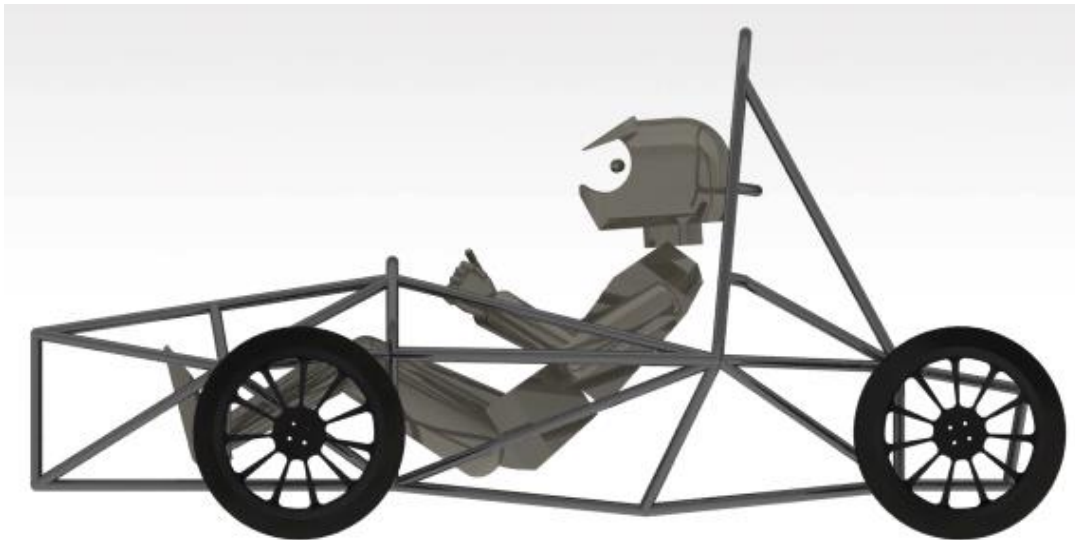
Figura 1.128. Disseny final del xassís (pilot i rodes). Font pròpia (ANSYS Mechanical).
