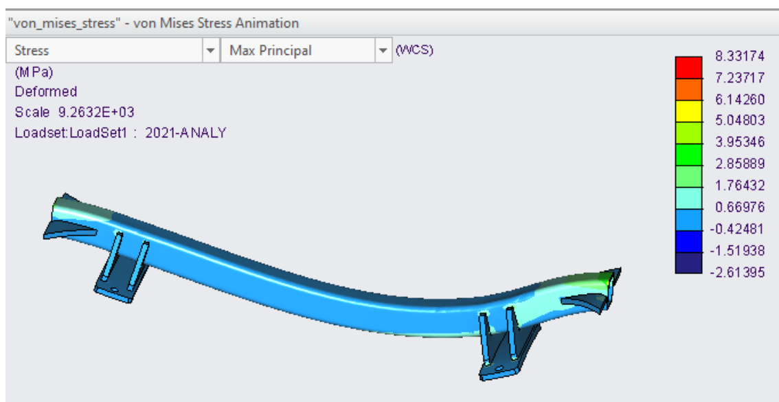
Il·lustració 17 Tensió màxima principal Creo Simulate.
