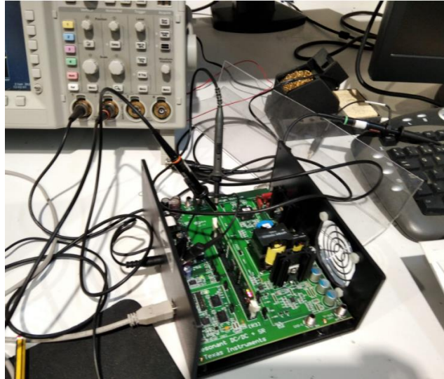
Figura 4.23. Connexió per mesurar el PWM experimentalment sense tensió d'entrada
