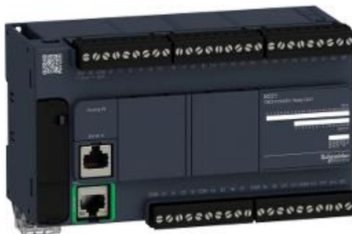
Figura 4. PLC de la marca Schneider Electric , model TM221CE40R
