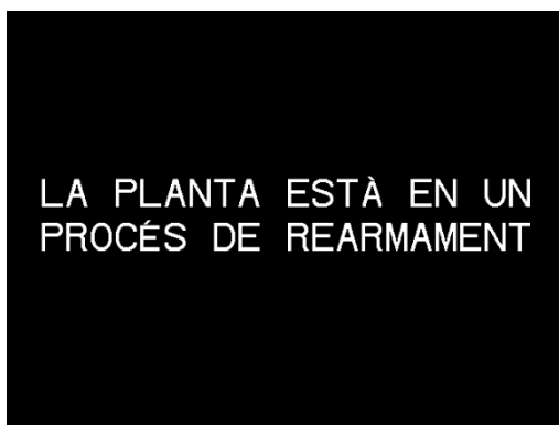
Figura 73. Pantalla de l'HMI que indica que la planta està sent sotmesa a un rearmament i que està tornant a l'estat de parada inicial
