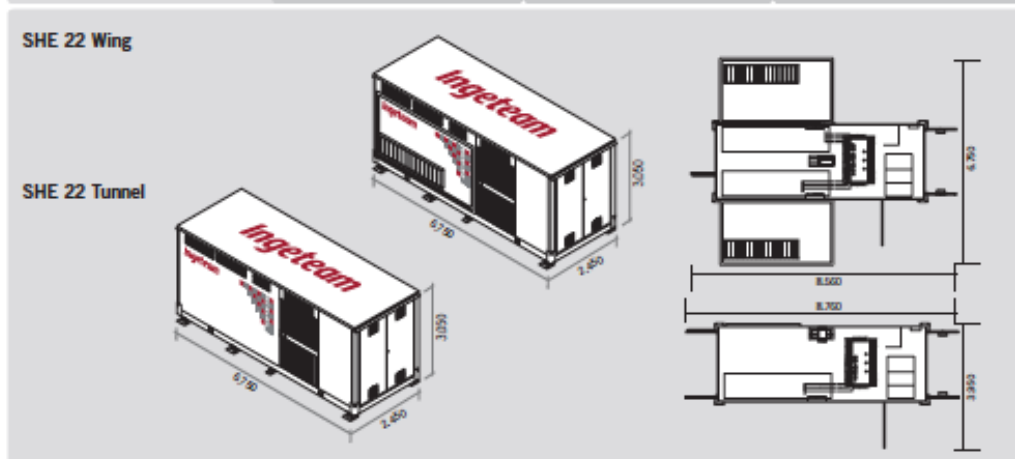
Taula 4 Característiques de l'estació INGECON SUN POWERSTATION SHE 22
