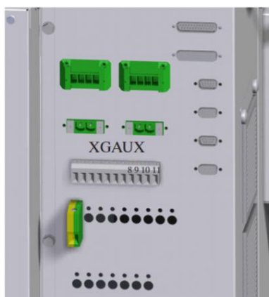
Figura 38. Conexiones del grupo electrógeno en el inversor
