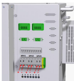
Figura 33. Entradas del módulo fotovoltaico
