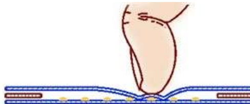
Figura 5: Representació del panell tàctil resistiu
