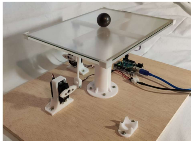
Figura 66: Estructura final del sistema ball & plate
