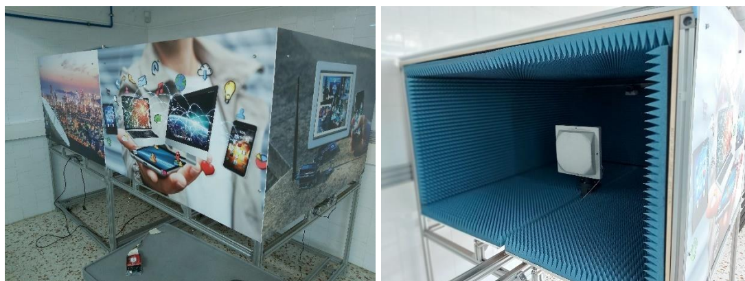
Figura 22. Cámara anecoica donde se realizaron las pruebas experimentales
