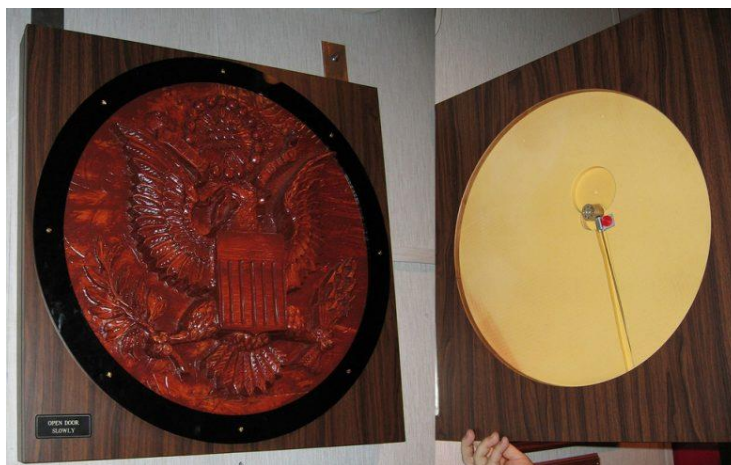
Figura 1. Imagen de La Cosa, que contenía el primer prototipo de tag pasivo creado por León Theremin en el año 1945
