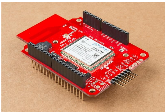
Figura 17. SparkFun Simultaneous RFID Reader - M6E Nano, “shield” compatible con Arduino Fuente: https://learn.sparkfun.com/tutorials/simultaneous-rfid-tag-reader-hookup-guide/all
