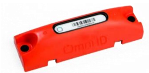
Figura 6. Ejemplo de etiqueta de RFID activa
