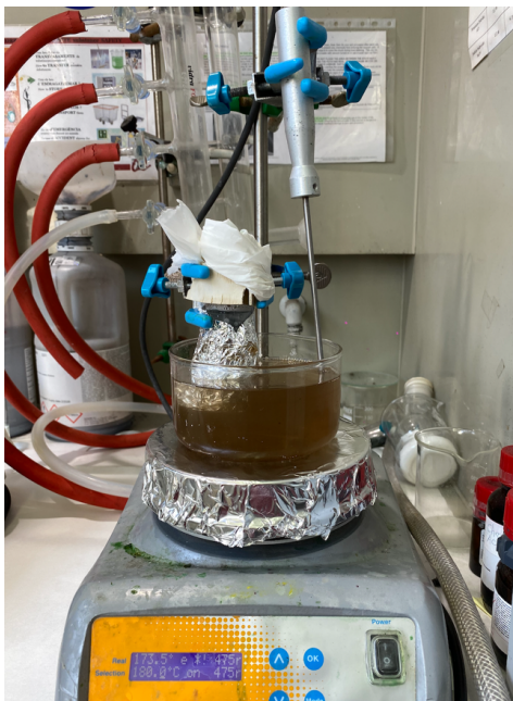
Figura 30. Proceso de la hidroxilación de las muestras, modificación química de la superficie añadiendo grupos hidroxilos.
