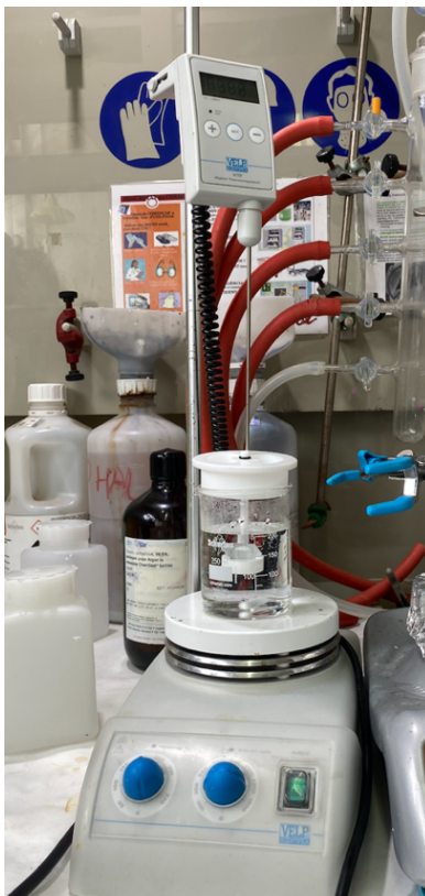
Figura 20. Montaje para el proceso de pore widening, muestras introducidas en ácido fosfórico a 35 °C.
