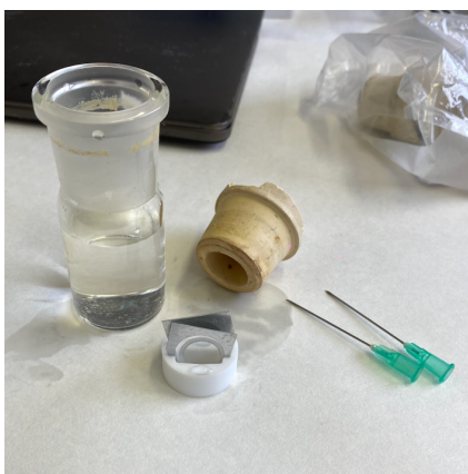
Figura 28. Material necesario para la hidroxilación. Tubo, septum, peróxido de hidrógeno, soporte para las muestras y agujas.
