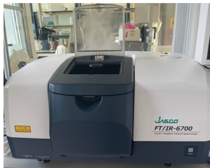
Figure 19. FT/IR-6700 in the area of Servei de Recursos Científics i Tècnics at the URV.
