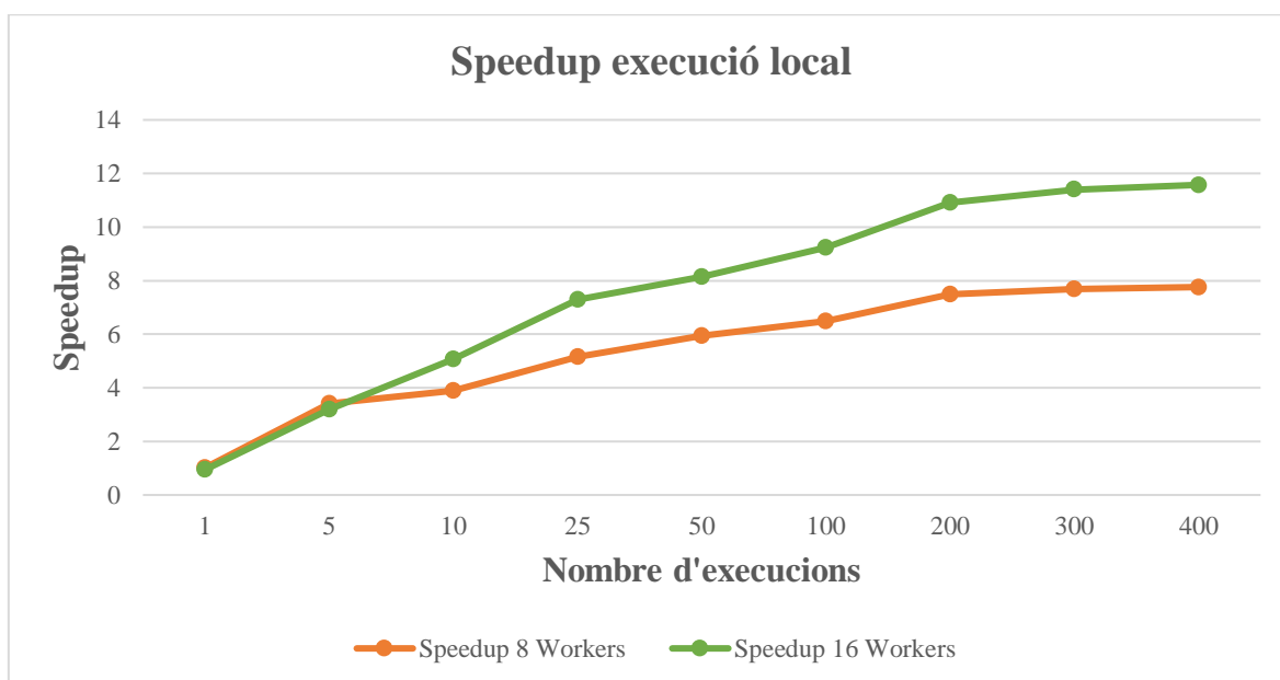
Figura 23. Gràfica Speedup execució local
