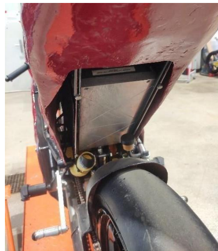
Figura 1.4 i 1.5: Incorporació de tubs per augmentar el flux d'aire. (Font: Imatge pròpia)
