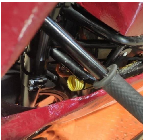
Figura 1.4 i 1.5: Incorporació de tubs per augmentar el flux d'aire. (Font: Imatge pròpia)
