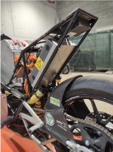
Figura 1.2 i 1.3: Col·locació de l'inversor a la motocicleta. (Font: Imatge pròpia)
