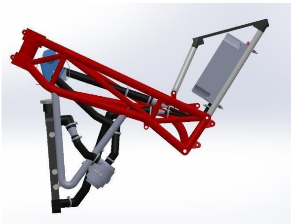
Figura 1.14 i 1.15: Integració del dipòsit al xassís. (Font: Imatge pròpia)
