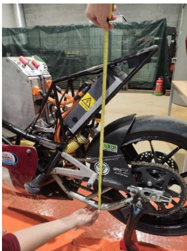
Figura E.3: Alçada de l'inversor respecte el sòl (Font: imatge pròpia)
