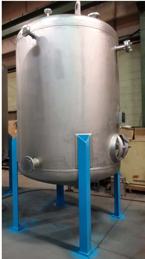
Figura C. 2: Suportació d'equip mitjançant potes
