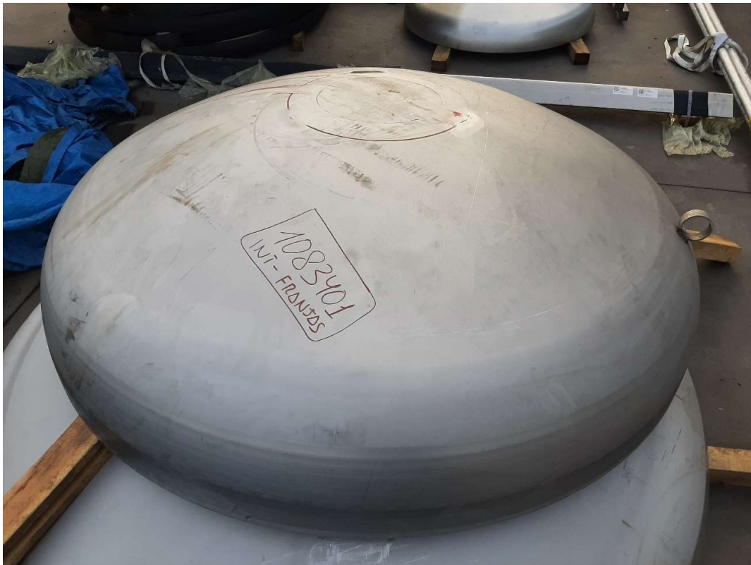
Figura C. 15: Fons superior i inferior tipus Korbogen del reactor R-2000
