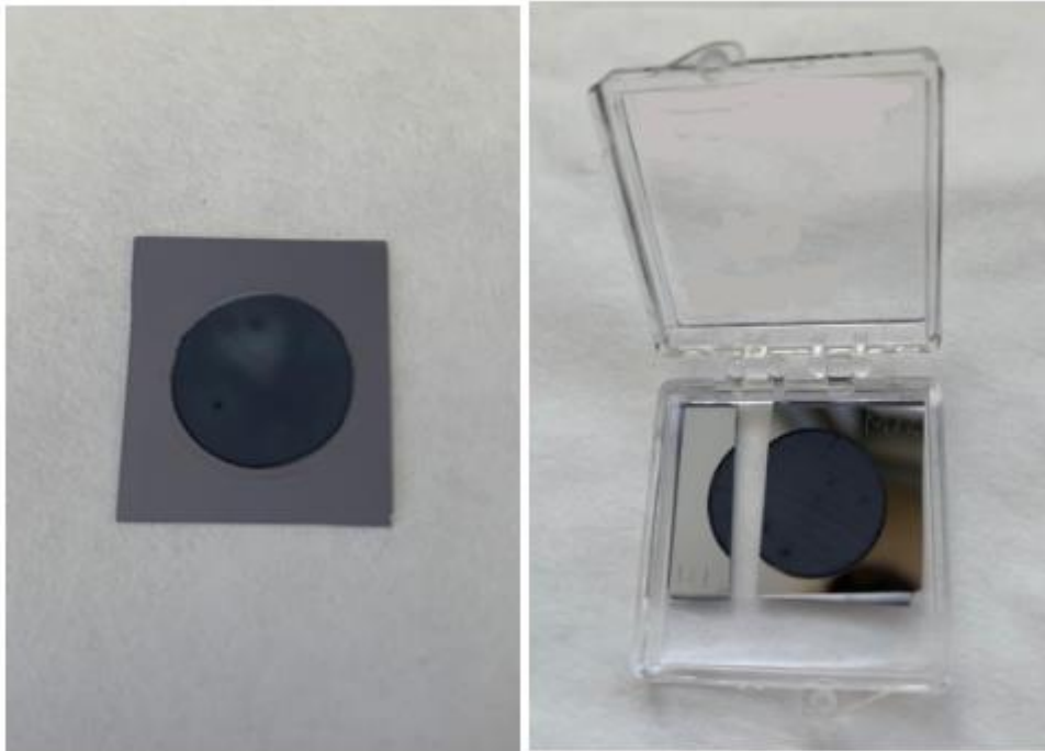
Figura 21. A la izquierda muestra muestra de silicio poroso acabada de fabricar. A la derecha muestra muestra cortada para su caracterización en el microscopio y guardada en caja de plástico.
