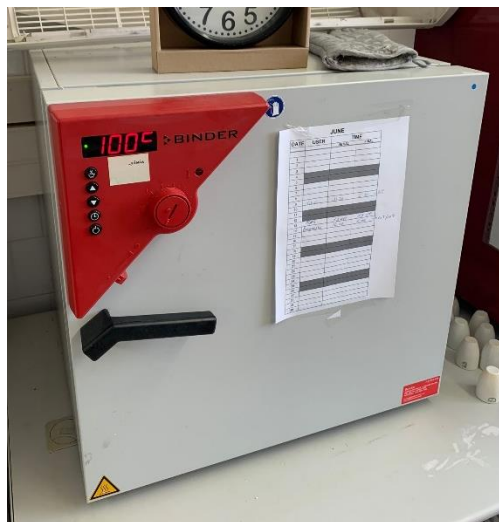
Figura 15. Horno utilizado para la fijación del APTES a la superficie
