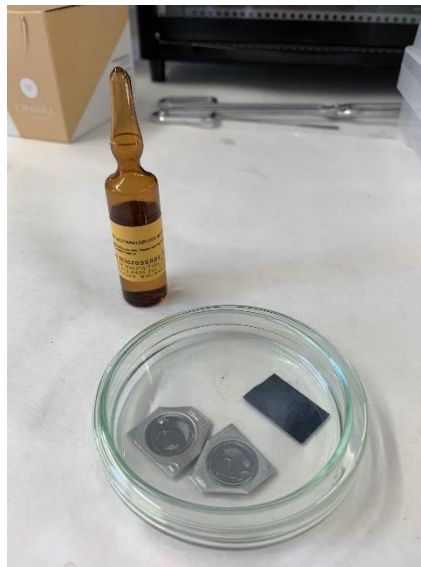
Figura 17. GTA al 2.5% en etanol junto con las muestras de SiP.
