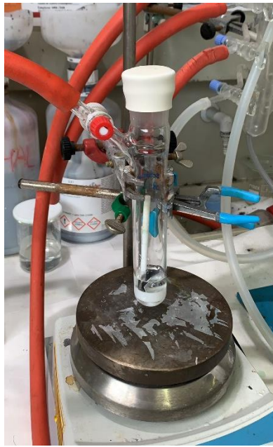
Figura 13. Montaje para la silanización sobre agitador y con atmósfera de nitrógeno.
