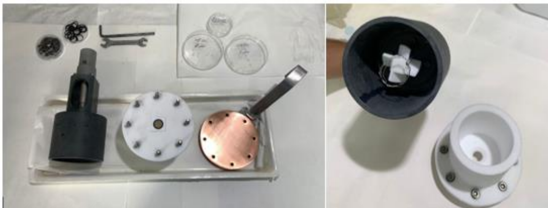
Figura 3. Material utilizado para la anodización. Placa de cobre, recipiente para el ácido y el agitador con el filamento de platino. [11, 12, 13]
