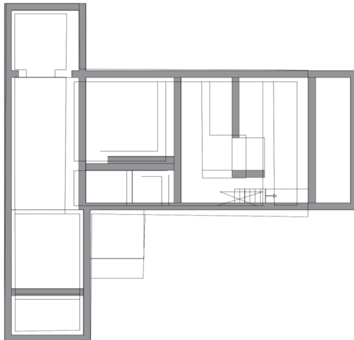
Figura 18. Comparació del plànol de la planta superior de l'edifici de custòdia tal com el trobem a la placa de marbre (plànol lineal simple) i després de la reelaborar-ho amb mesures i escales proporcionals (plànol ombrejat).
