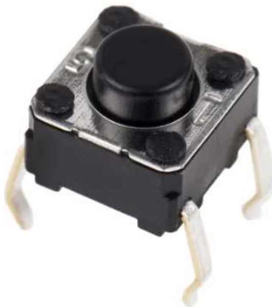
Figura 2. Imagen de un micro pulsador de la web rs-online.com.
