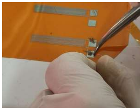
Figuras 83 y 84. Adición de pasta de plata (izquierda) y colocación de hilo (derecha).
