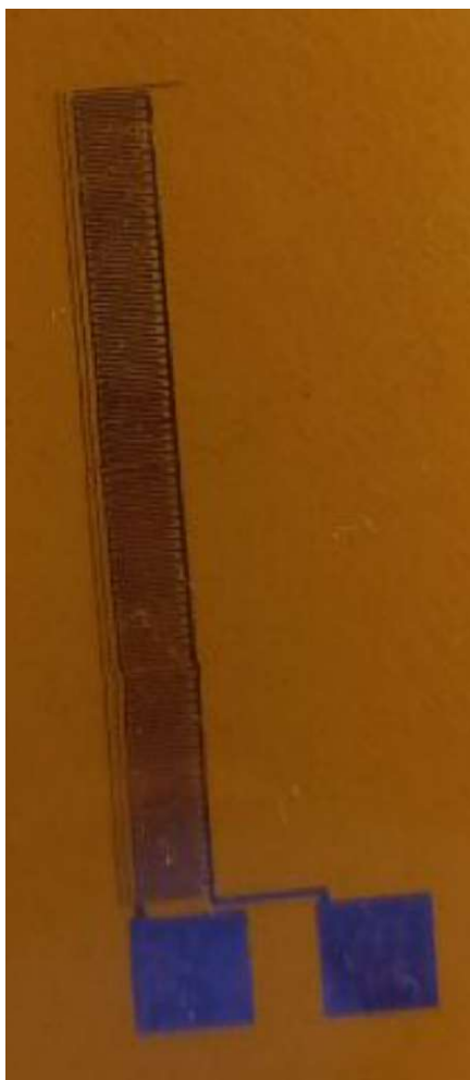
Figura 72. Resultado interdigitado continuo vertical (tinta de plata).
