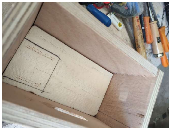
Figura 40. Capa de poliespán en la base.
