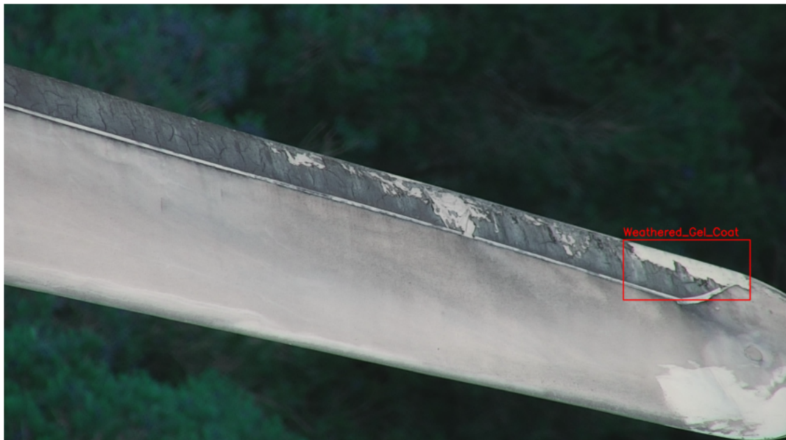
Figura 11: Exemple gel coat desgastat. Font: EbreDrone
