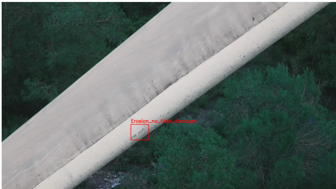
Figura 9: Exemple erosió sense dany a les fibres. Font: EbreDrone
