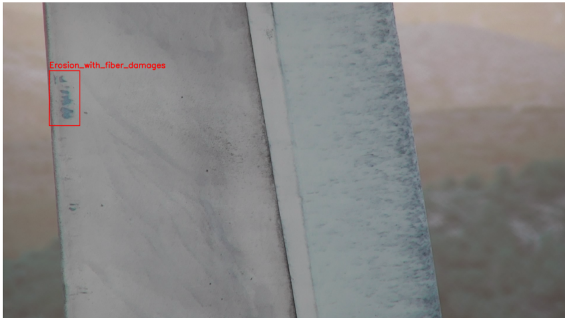
Figura 8: Exemple erosió amb dany a les fibres. Font: EbreDrone
