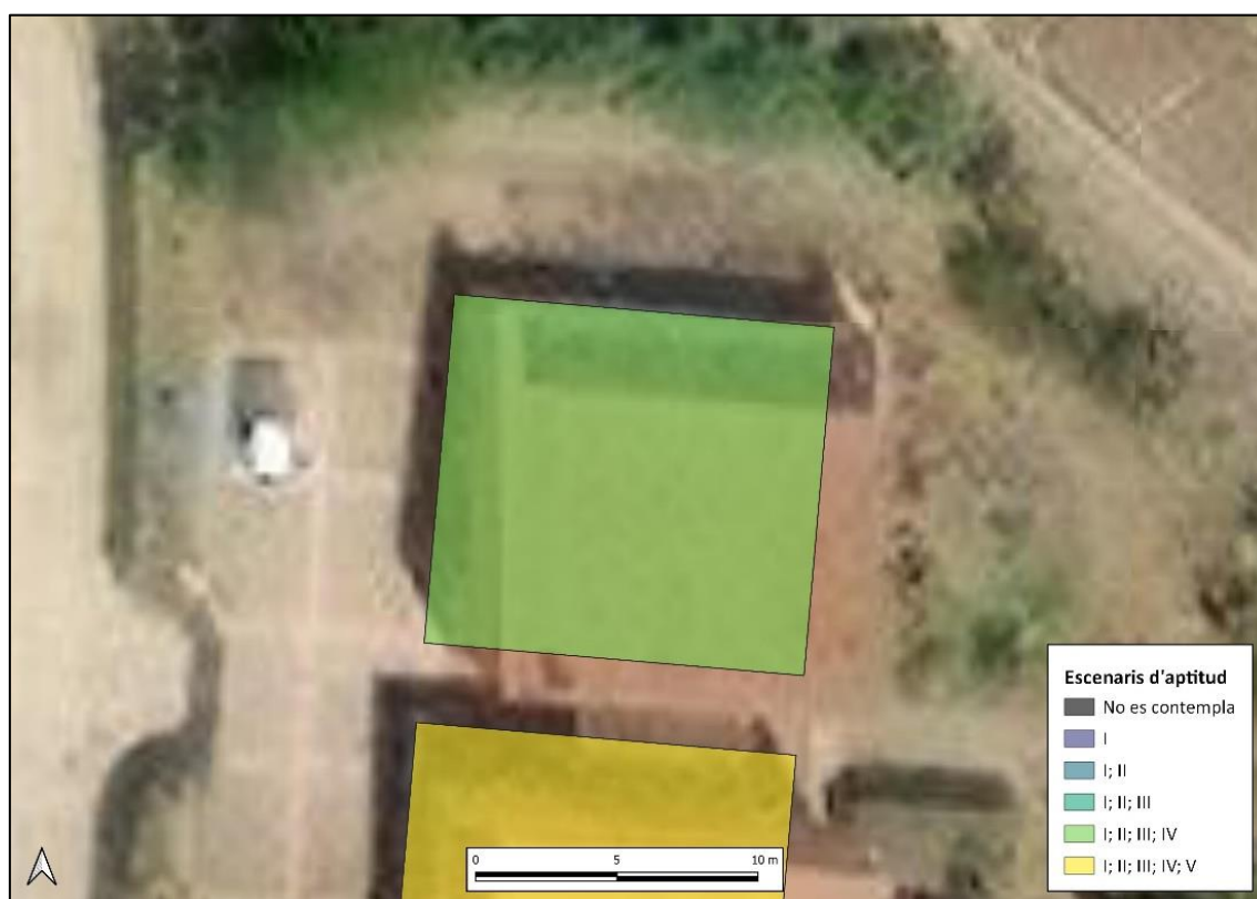
Figura 22. Exemple de coberta en un entorn rural del municipi d'Alforja amb aptitud fins l'escenari IV per a instal·lar plaques fotovoltaïques.
