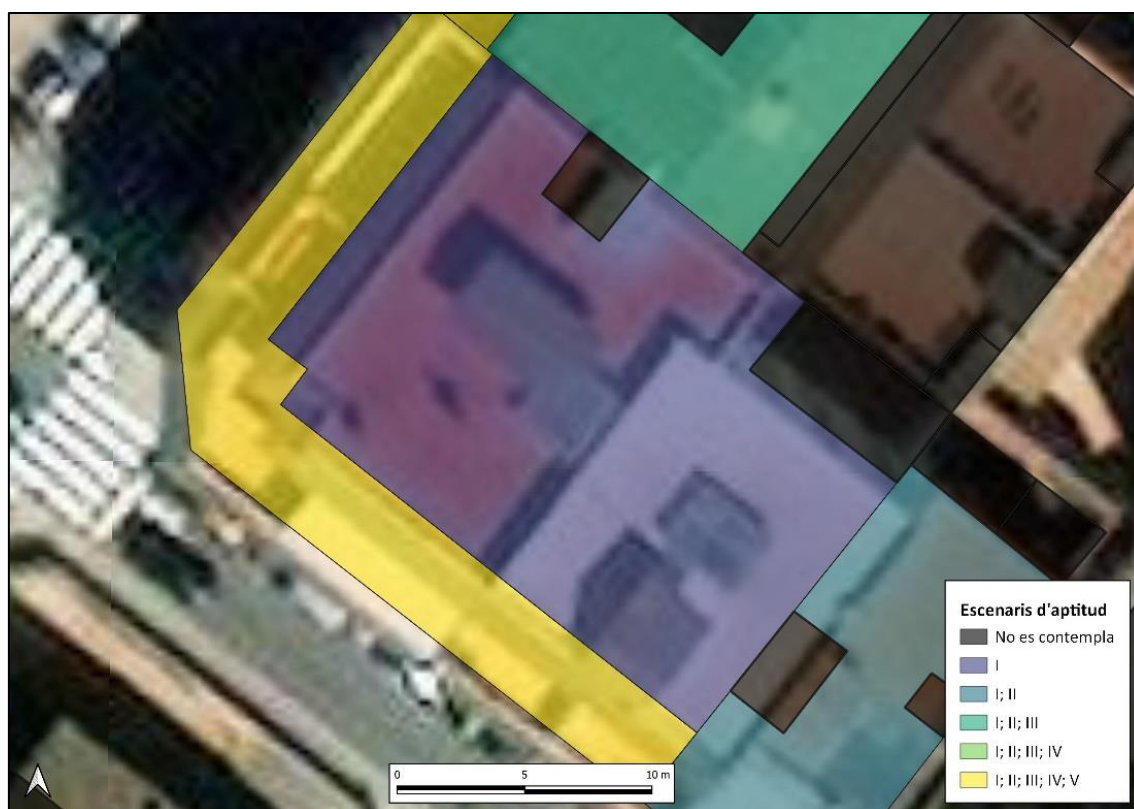
Figura 19. Exemple de coberta urbana del municipi del Vendrell amb aptitud fins l'escenari I per a instal·lar plaques fotovoltaïques.
