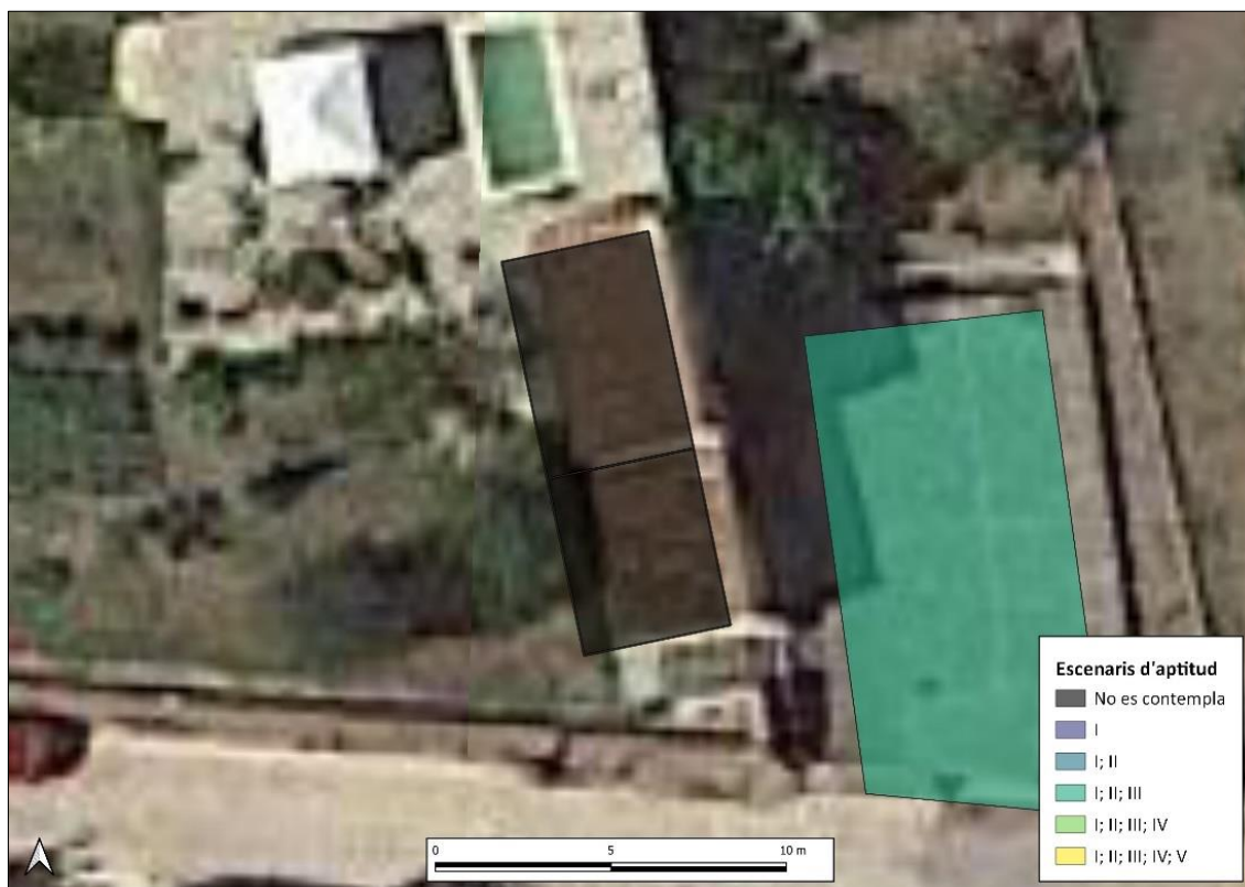
Figura 18. Coberta del municipi de Prades sense aptitud per a instal·lar plaques fotovoltaïques descartada per tenir una superfície menor a 10 m 2 .
