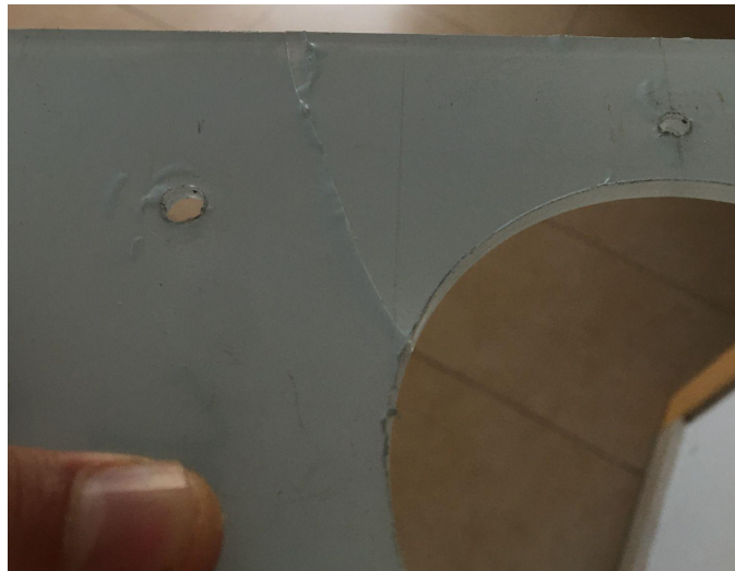
Figura-29. Segona ruptura deguda a cargol.
