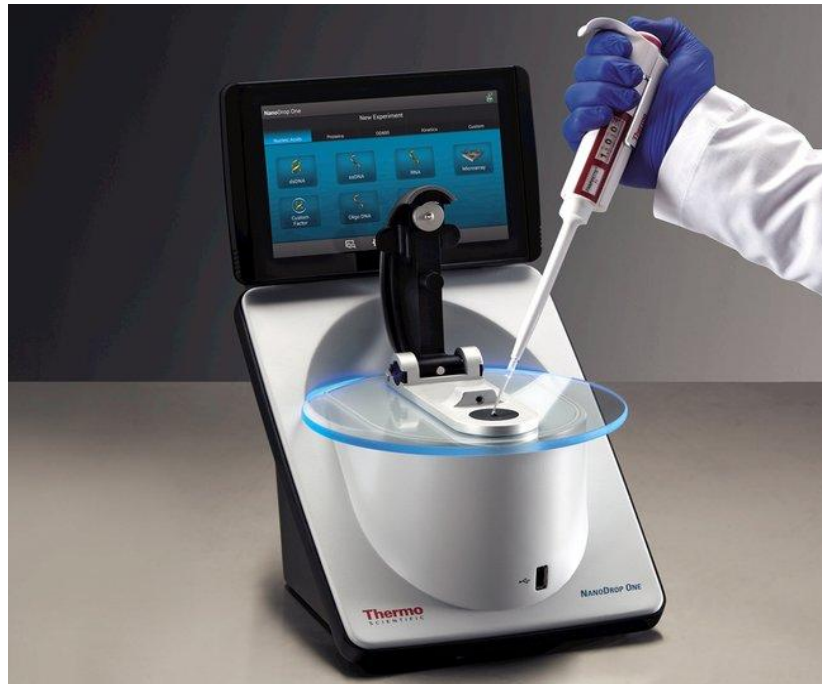
Figura 8: Modelo de la Máquina Nanodrop utilizada. En la foto, la pipeta indica dónde va la gota a analizar de 1 \mu l. Con una tapa imantada para que cierre bien. Imagen extraída de la referencia (21).
