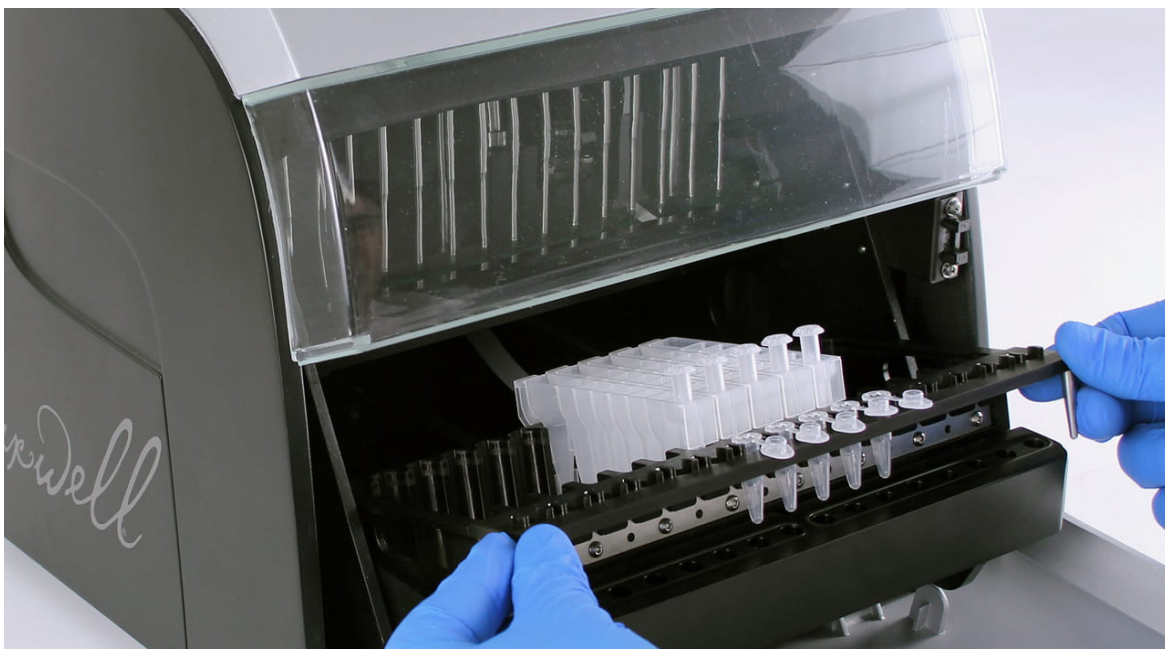
Figura 7: Modelo de la Máquina Maxwell utilizada. Foto cargada con 5 cartuchos, 5 puntas y 5 tubos colectores. Obtenida de la referencia (20).
