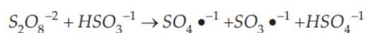
Figura 4.9 Iniciadors tèrmics: a. Persulfats b. Peròxid d'hidrogen c. Peròxid orgànic d. Compostos Azo; Iniciadors redox: e. Sistema persulfat-bisulfat. 4
