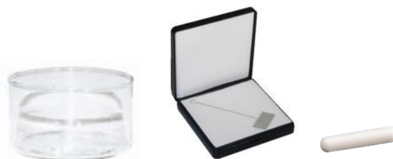
Figura 5.1 Vas de precipitats 70mm de diàmetre, Wilhelmy plate i imant.
