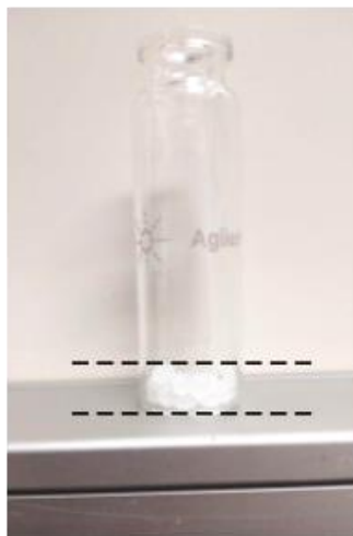
Figura 7- Nivel de llenado del vial de muestra.
