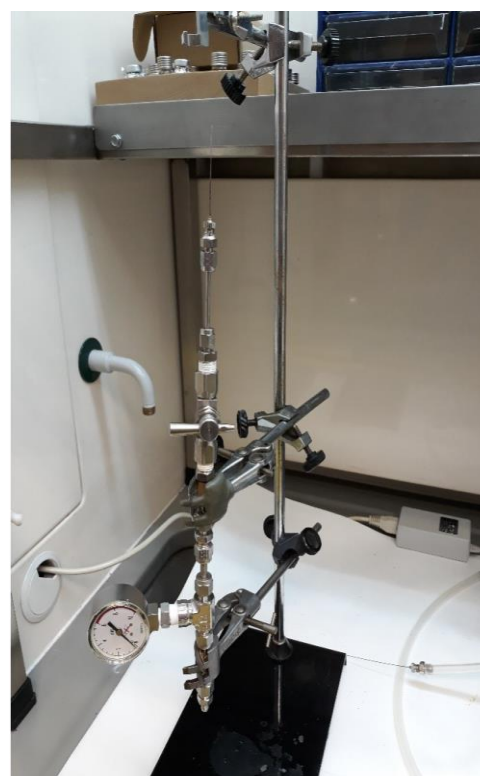
Figura 5 - Transferencia gas patrón de botella a vial
