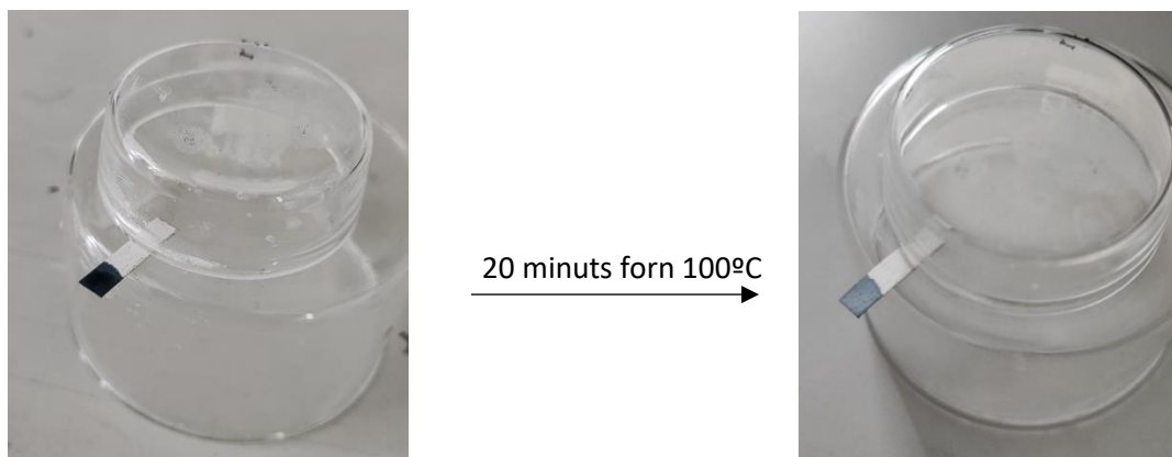
Figura 10 Diferència del PEDOT:PSS abans i després del forn
