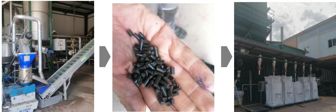
Figura 16. Processament d'assecat a la planta de Deseuras. Assecat > Pel·letització > Fertilizant.
