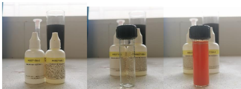
Figura 9. Reactius per determinar el Nitrogen amoniacal. Cubeta de 10 mL amb les gotes de cada reactiu afegides.
