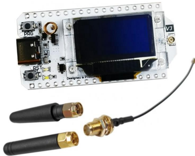
Figura 4.12. Heltec WiFi LoRa 32 (V3).
