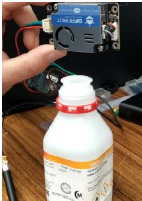
Figura 5.2. Pot d'acetat de trans-2-Hexenil sota el sensor de PM de DFRobot.
