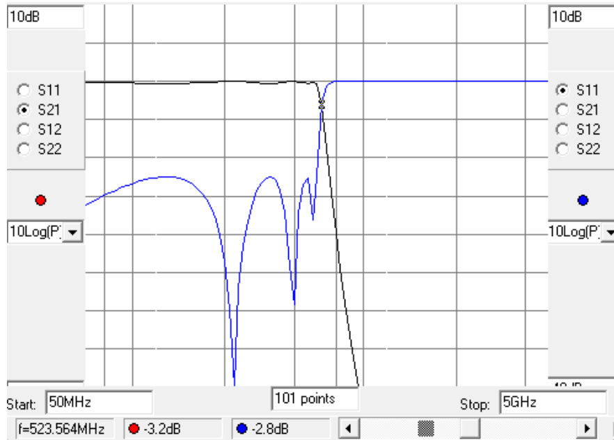
Figura 3.2. Simulació dels paràmetres S21 (vermell) i S11 (blau).
