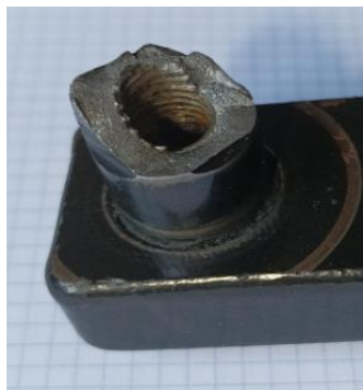
Fig. 2. 9 Secció circular de la part de la peça de l'AirBike que trenca. Font: pròpia.
