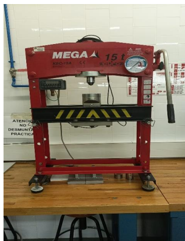
Fig. 1. 18 Màquina d'assaig duresa Brinell. Font: pròpia
