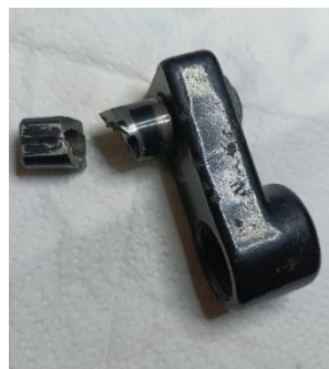
Fig. 1. 2 Peça trencada de l'AirBike. Font: pròpia
