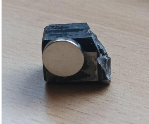
Fig. 2. 2 Comprovació propietats magnètiques material. Font: pròpia
