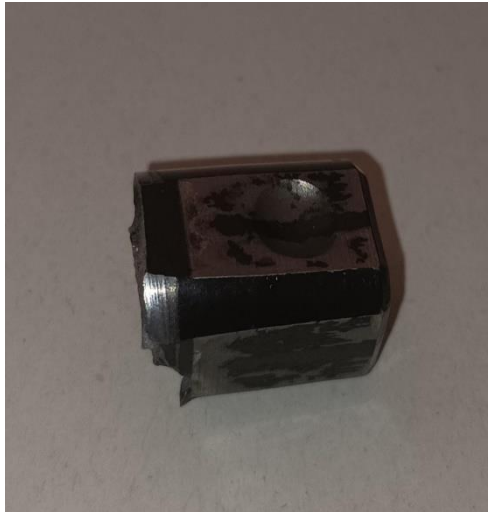
Fig. 2. 5 Marca deixada per l'identador sobre la peça a analitzar després de realitzar l'assaig de duresa Brinell. Font: pròpia
