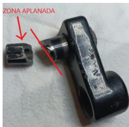
Fig. 1. 40 Secció trencada de la peça. Font: pròpia.
