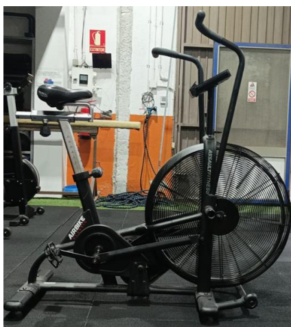
Fig. 2. 15 Posició del pedal en angle de 180° respecte a l'horitzontal. Font: pròpia L'esquema de forces de la Figura 2.16 mostra amb més claredat aquestes posicions i les forces que actuen.
