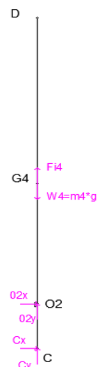
Fig. 1. 23 Diagrama del sòlid lliure del manillar mòbil. Font: pròpia
