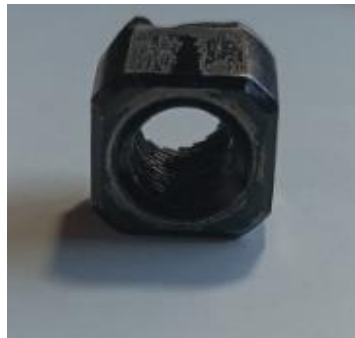
Fig. 2. 8 Secció quadrada de la part de la peça de l'AirBike que trenca. Font: pròpia.
