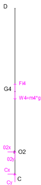
Fig. 2. 40 Diagrama del sòlid lliure de la baula formada pel manillar. Font: pròpia.
