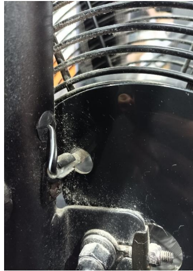
Fig. 2. 21 Sensor de velocitat AirBike. Font: pròpia.
