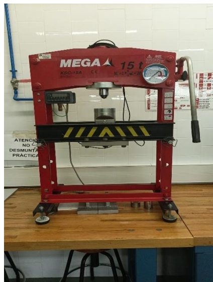
Fig. 2. 3 Màquina d'assaig duresa Brinell. Font: pròpia
