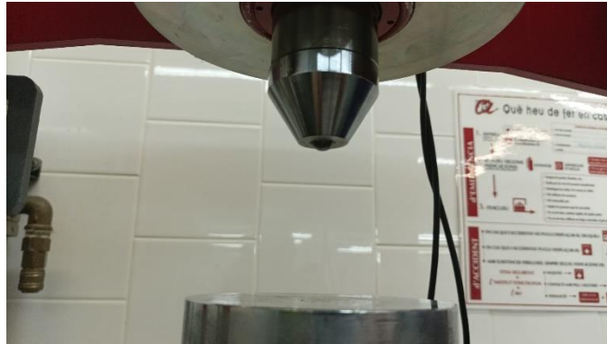
Fig. 2. 4 Bola de carbur de tungstè de 10 mil·límetres de diàmetre de la màquina d'assaig de Duresa Brinell. Font: pròpia.
