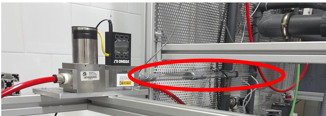
Figura 21. Muntatge del tub per a calibrar el sensor que s'utilitzarà en les proves.
