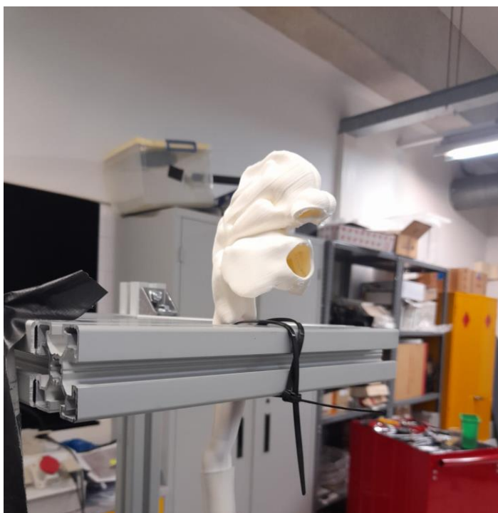
Figura 9. Model de les vies respiratòries superiors imprès en 3D en què es basa l'experiment.
