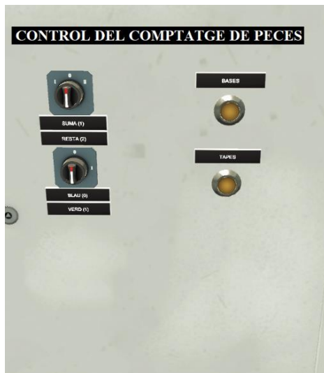
Figura 16. Mòdul esquerre del bloc 1: Botonera 2. Control de comptatge de peces
