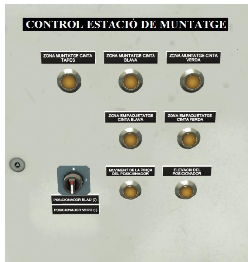
Figura 21. Mòdul dret del bloc 3: Botonera 6. Control estació de muntatge
