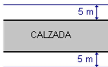
Figura 5. Esquema de la calzada para el cálculo del coeficiente de iluminación.
