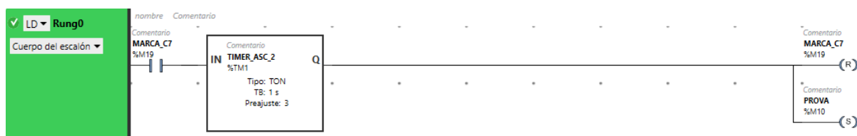
Figura 19. Contacte temporitzador de la cinta transportadora
