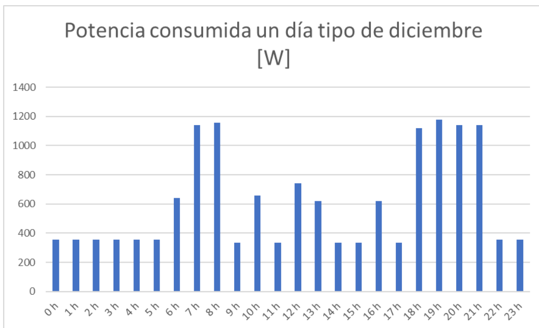
Ilustración 15 Gráfico de potencia consumida un día tipo de diciembre por horas.
