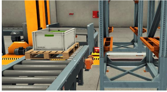
Figura 40. Palet detectat pel sensor i preparat per ser emmagatzemat
