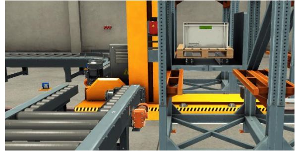
Figura 43. La cistella del transelevador es col·loca davant de la posició on s'emmagatzema el producte
