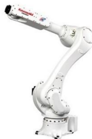
Figura 59. Robot Kawasaki Serie RS RS020N
