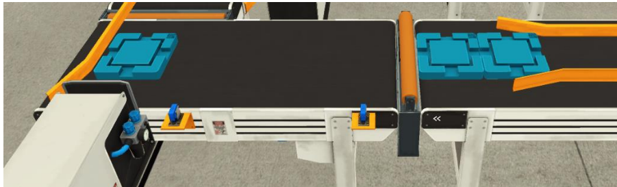
Figura 21. Cinta aturada i barrera de rodets activada
