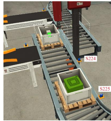
Figura 38. El sensor S225 detecta el palet i es reprèn el subministrament de les caixes
