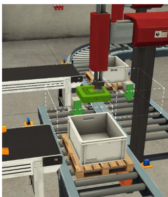
Figura 107. S'ha aturat la planta quan el Pick & Place d'empaquetatge té agafada la peça i es troba sobre la caixa
