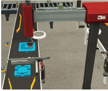
Figura 101. S'ha aturat la planta quan el Pick & Place d'encaixament té agafada la tapa i es dirigeix a col·locar-la sobre la base
