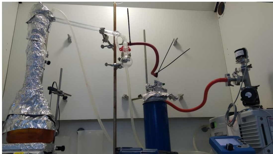
Figura 11 Muntatge de la destil·lació amb columna.
