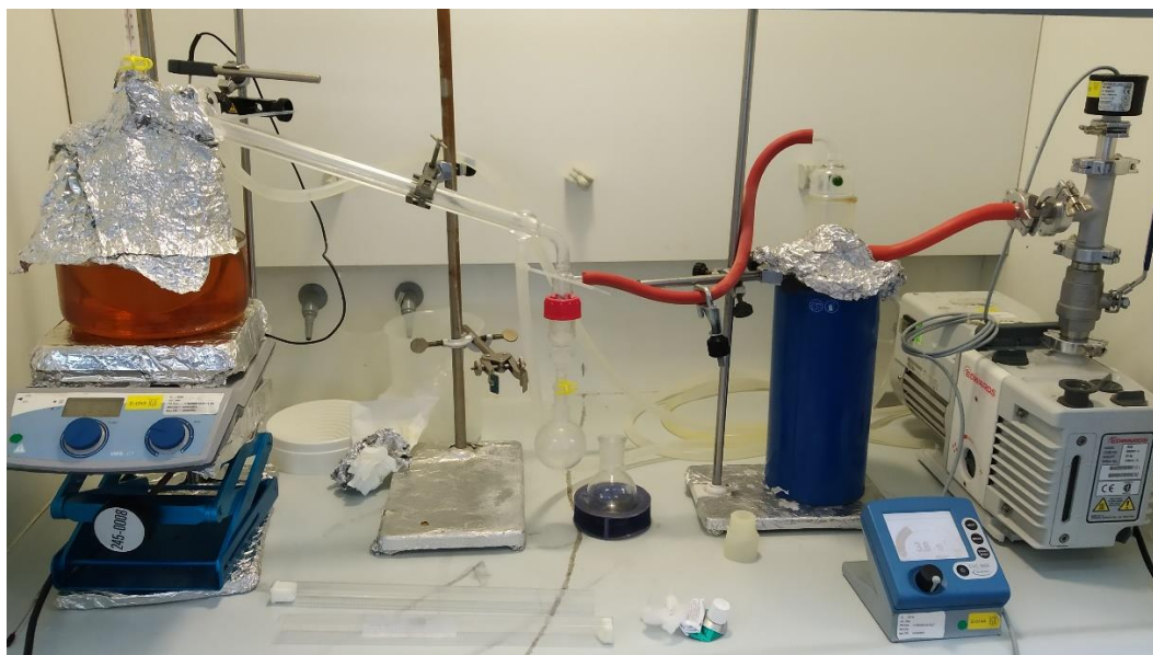
Figura 10 Muntatge de la destil·lació sense columna.
