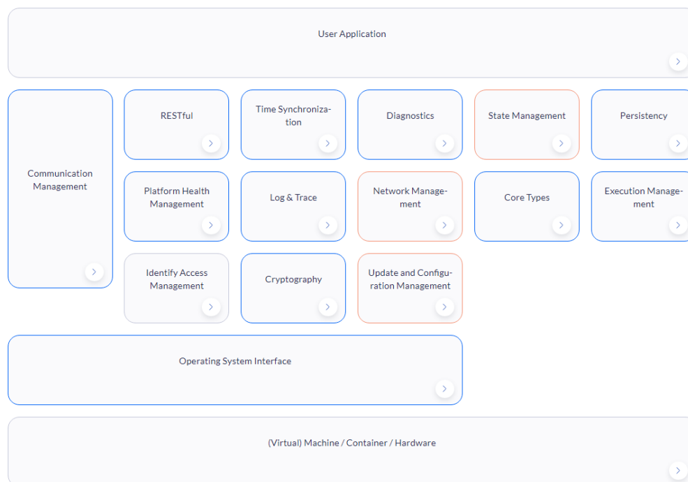
Figura 9: Diagrama de capes de la plataforma AUTOSAR Adaptive
