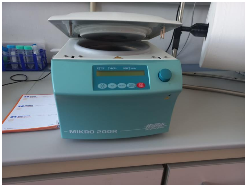
Imatge 11: Centrifuga refrigerada Heittek Mikro 200R
