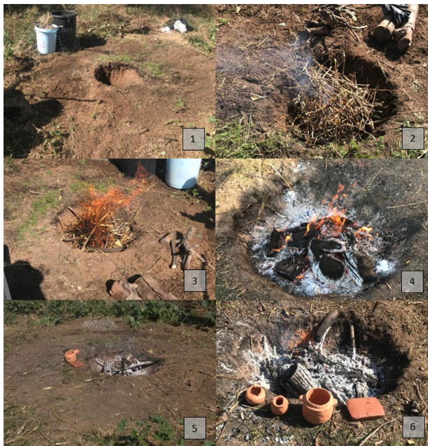
(Fig. 8) [1] Pit kiln excavado en el centro de un área despejada para este propósito. [2 y 3] Encendemos una hoguera en el hoyo y la alimentamos hasta conseguir una llama alta [4] Continuamos alimentándola hasta que se forme una cama de ascuas lo bastante tupida. [5 y 6] Conforme la llama va bajando su intensidad vamos acercando las vasijas gradualmente, hasta prácticamente dejarla apagarse. Fotografías: Aurora Patiño Ochoa y Miguel Gimeno Coll, 2023.
