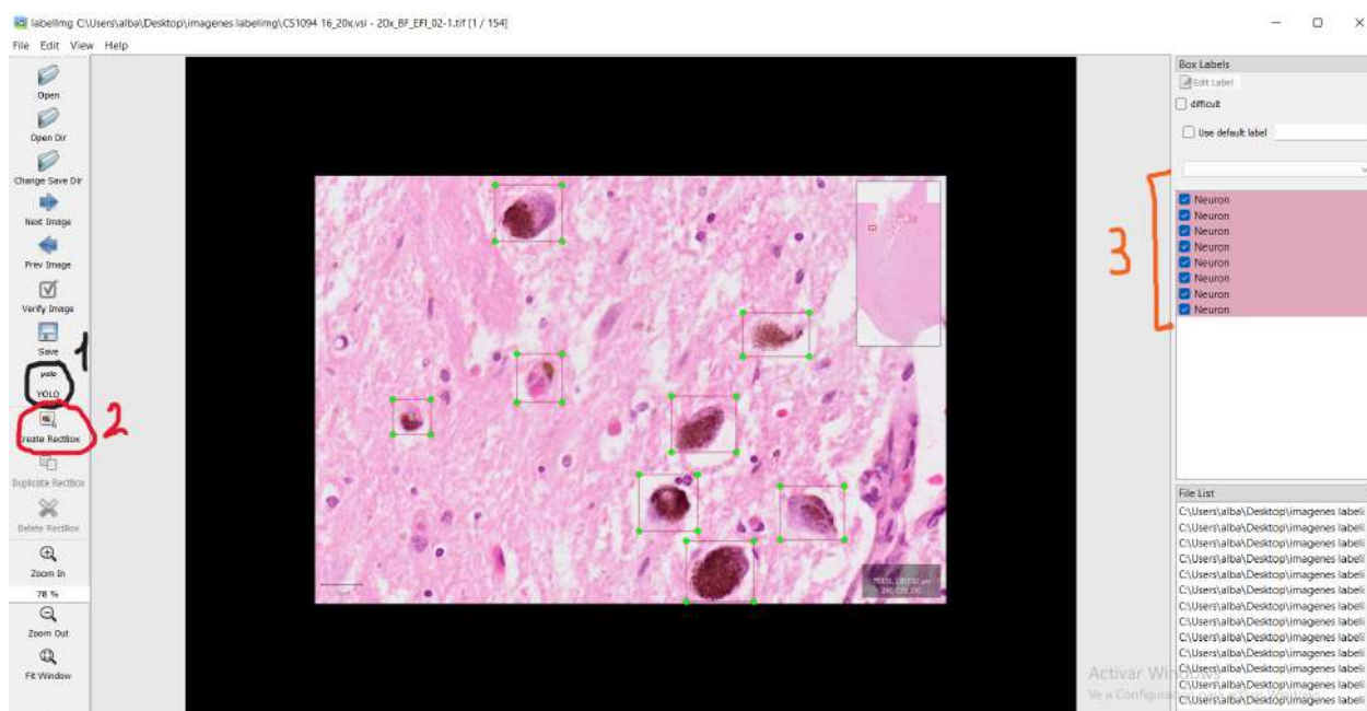
Figura 57 - Proceso de etiquetado de imágenes con LabelImg . El primer paso indicado con el número 1 es cambiar el formato a YOLO, posteriormente (2) seleccionamos “ Create Rectbox ” para cada neurona donde queremos dibujar su bounding box , finalmente en el paso 3 tenemos los objetos identificados.
