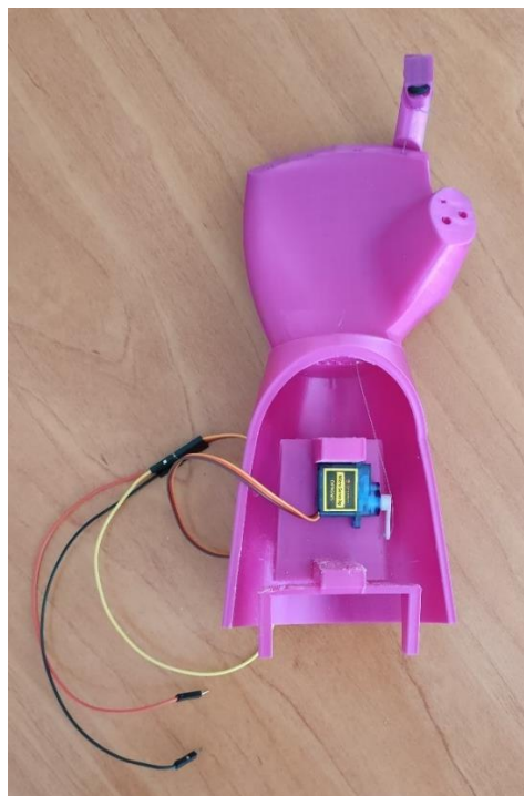
Figura 35. Pròtesi completament muntada amb el servomotor.
