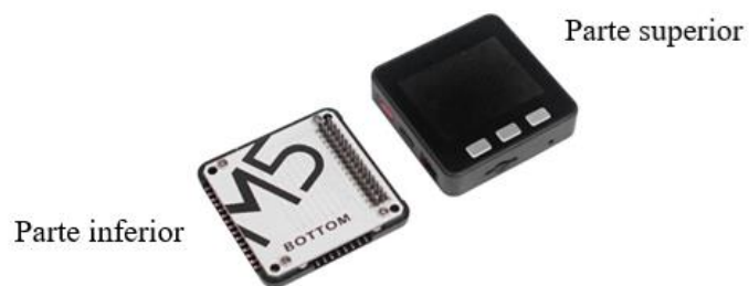
Figura 28. Partes del M5Stack ESP32 Basic Core.
