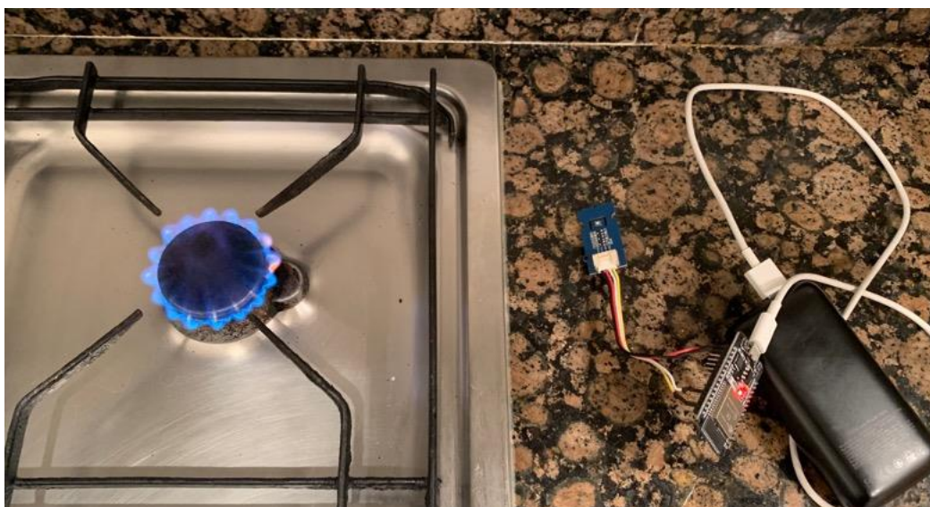
Figura 4.21. Muntatge per a poder analitzar la exposició de butà en una cuina de 7 m 2 .
