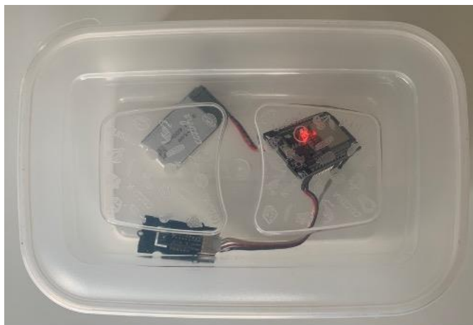
Figura 4.14. Muntatge caixa amb 0,5 ml d'acetona 100%.
