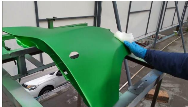
Fig 8.38. Ejemplo de aplicación de pintura opaca en base poliéster
