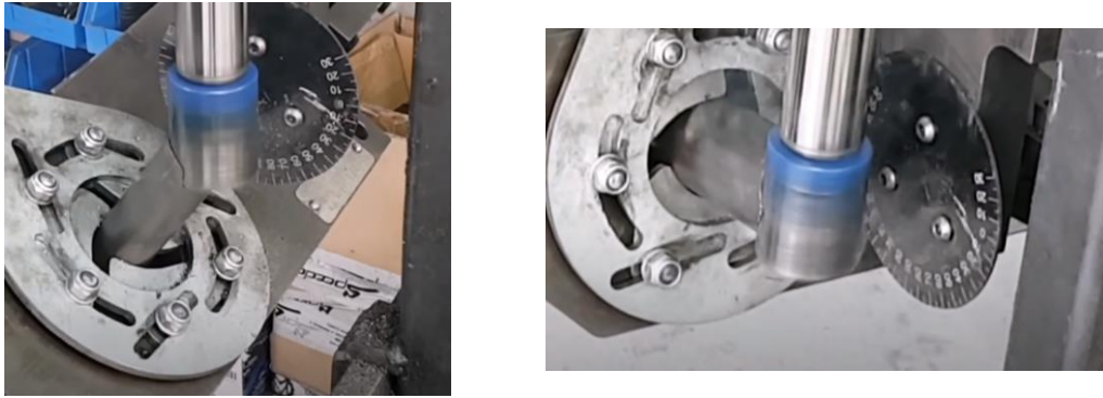
Fig. 8.32. Corte de tubos por mecanizado
