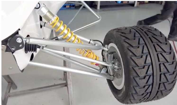
Fig. F.10. Suspensión frontal Speedcar Wonder
