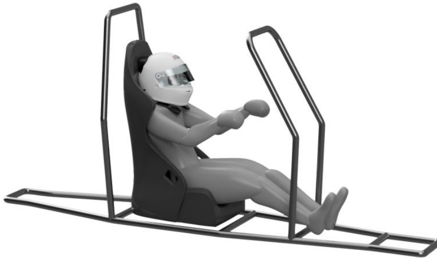
Figura G.9. Proceso de diseño: Modelado de los arcos frontal y principal
