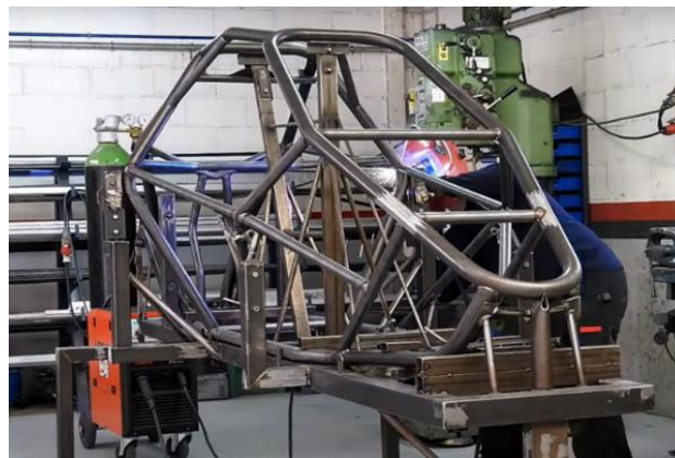
Fig. I.17. Speedcar XTREM sobre bancada durante soldadura TIG
