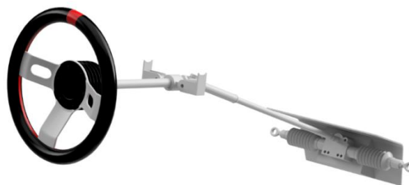
Fig. H.23. Visualización completa del modelo de dirección
