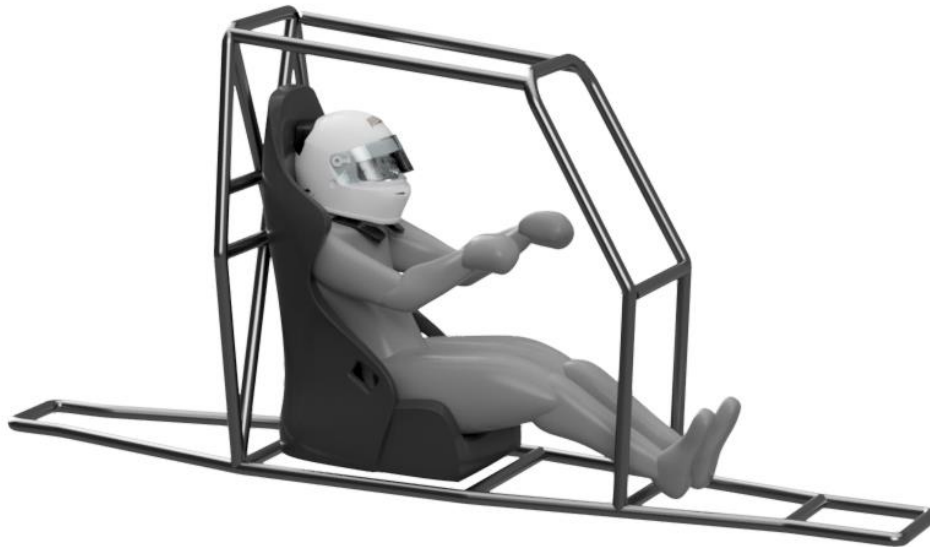
Fig.G.11. Proceso de diseño: Finalización y cierre de los arcos del chasis
