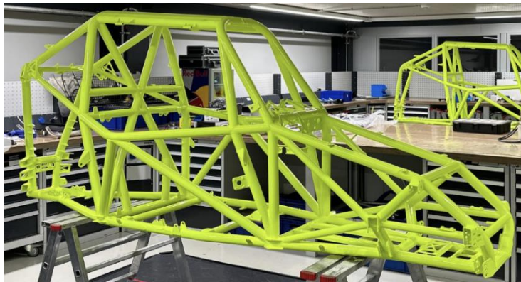
Fig. 3.7. Chasis Cross Car TN 11 finalizado sobre banquetas en taller
