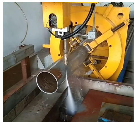
Fig. I.4. Corte de tubos por chorro de agua
