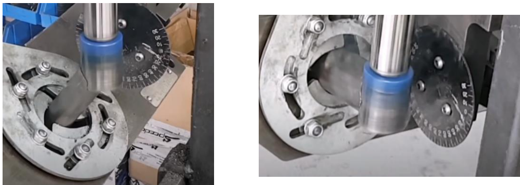
Fig. 1.5. Corte de tubos por mecanizado
