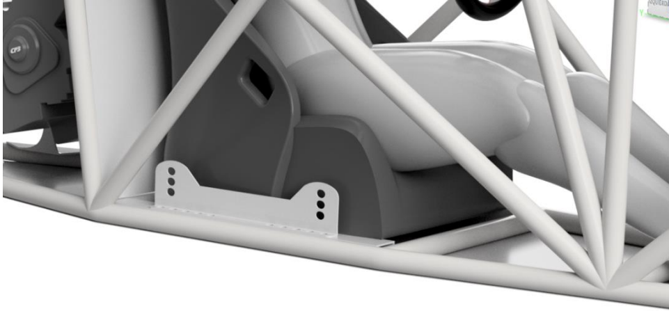
Fig. H.8. Visión general de la composición de los soportes del baquet
