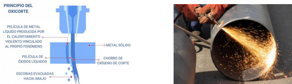
Fig. I.2. Proceso de oxicorte
