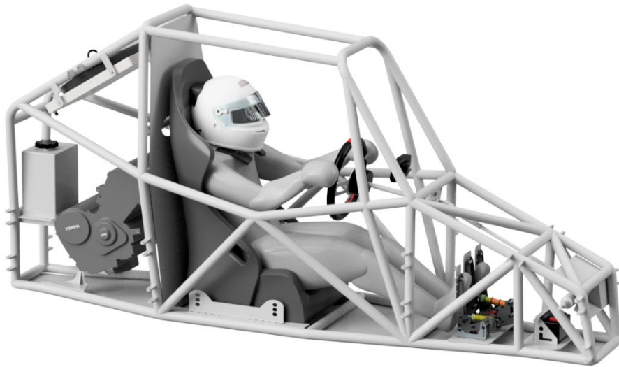
Fig. 8.1. Modelo 3D del chasis real
