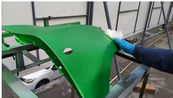
Fig. I.24. Ejemplo de aplicación de pintura opaca en base poliéster
