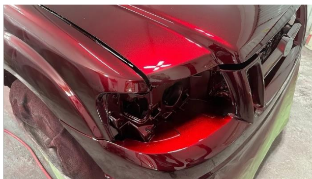
Fig. 1.23. Ejemplo de aplicación de pintura tipo candy en base de poliuretano
