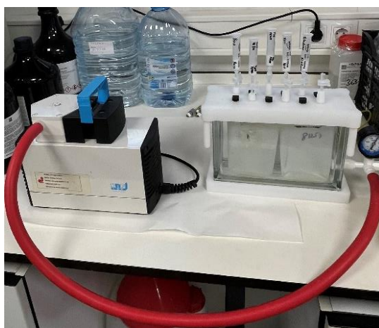
Figura 6: Neteja i assecatge del cartutx
