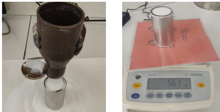
Figura 21. El cilindre metàl·lic enrasat amb la resina (esquerra), per a, posteriorment, pesar-lo (dreta).
