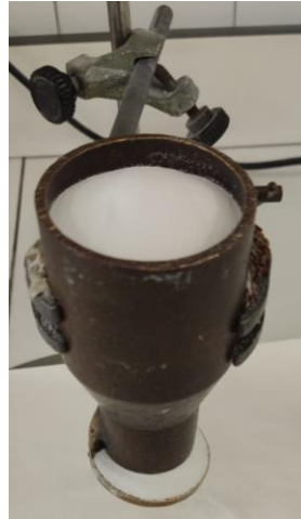
Figura 20. L'embut metàl·lic ple de resina.
