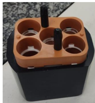
Figura 24. Tub de vidre amb els 4 mil·lilitres de plastificant DINP (esquerra). Recipient en el que s'introdueixen els tubs per a poder posar-los en la centrífuga (dreta).
