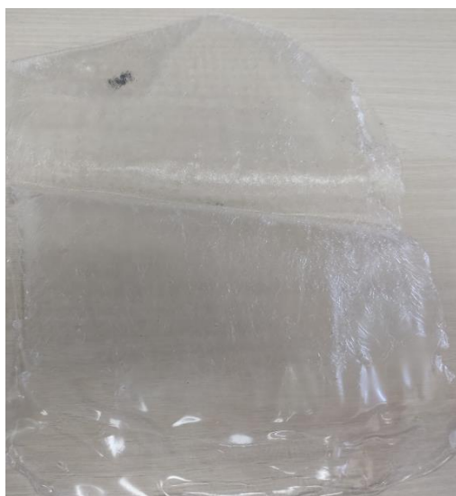
Figura 4. Primera làmina transparent obtinguda, és molt fina i s'observen unes arrugues (aigües).
