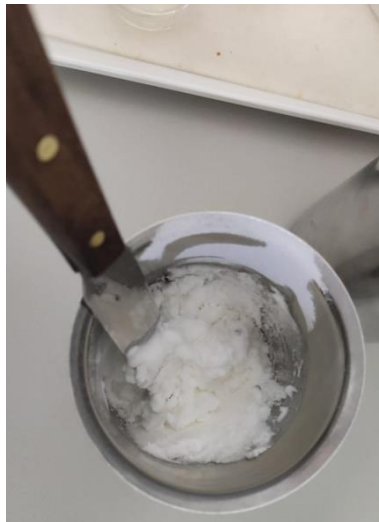
Figura 27. Mescla homogeneïtzada de PVC, colorant negre, estabilitzant i plastificant.
