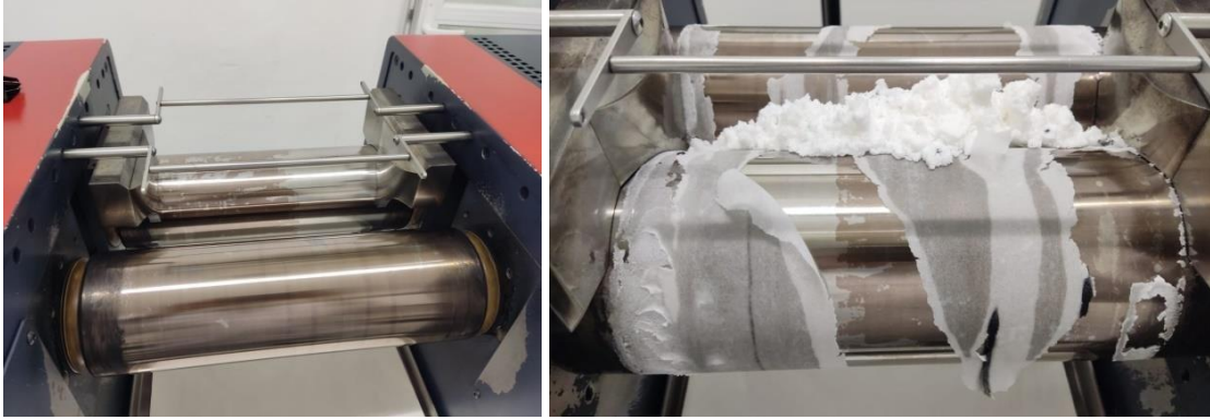
Figura 28. Els rodets del molí (esquerra). La mescla depositada sobre els rodets (dreta).
