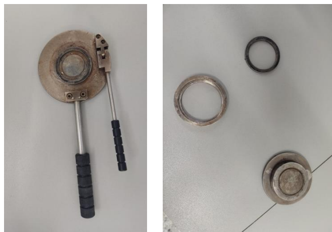
Figura 11. Motlle utilitzat per obtenir plaques rodones.
