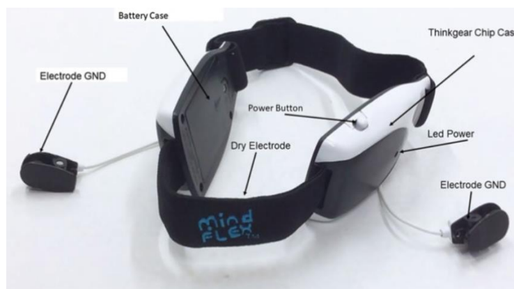
Figura 7. Diadema EEG del juguete MindFlex con partes seleccionadas. Fuente: (B.Serna, 2020)
