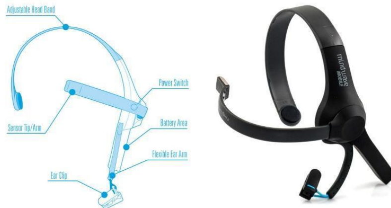
Figura 4. Dispositivo MindWave. Fuente: (Neurosky, Inc)
