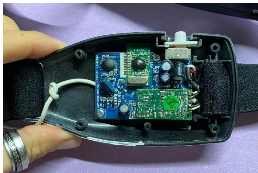
Figura 13. Fotografía de la diadema MindFlex desmontada.
