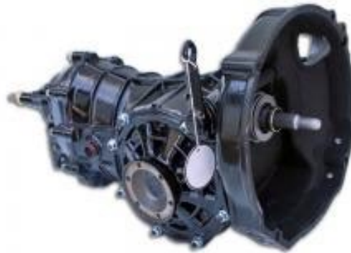
Figura 6 Ejemplo de caja de cambios personalizada para conversión de Volkswagen a eléctrico (1999 $)
