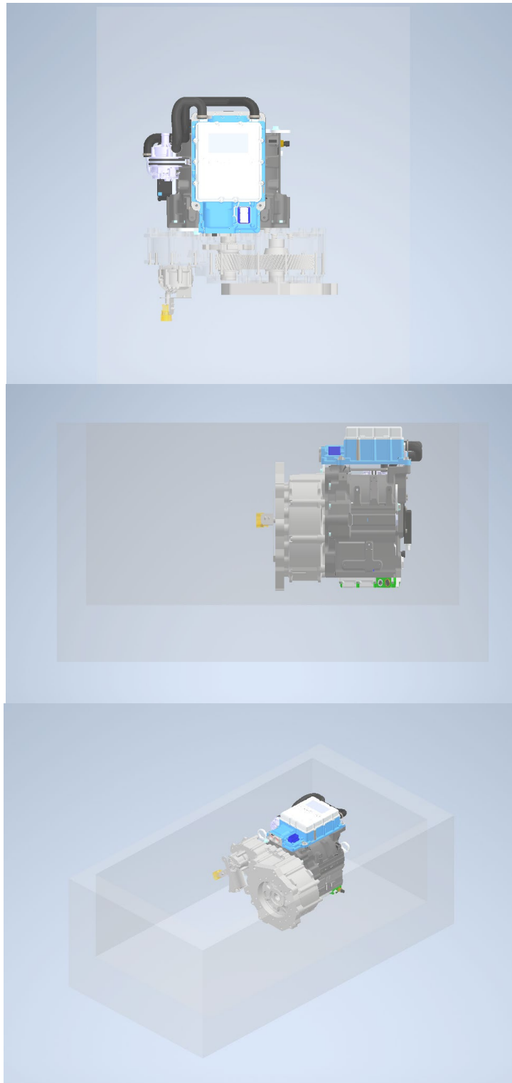
Figura 44 Vistas del encaje del motor eléctrico en la bahía del motor
