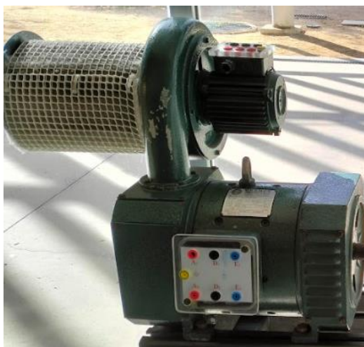
Figura 16. Generador de C.C de 4 kW
