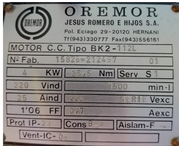
Figura 15. Placa de características del generador de C.C. de 4 kW
