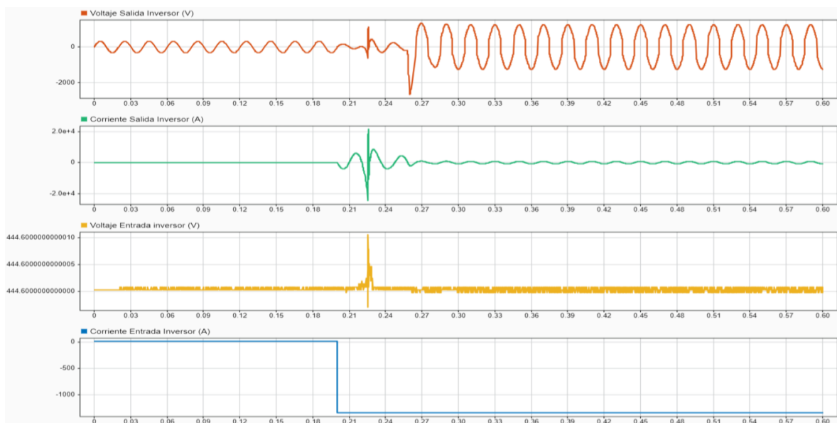
Figura 6-10: Corrent i voltatge a l'entrada i sortida de l'inversor sense fusibles de protecció
